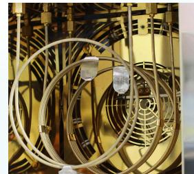
BASISを使用してキャリアガス流量を精度良く測定出来るため、ガスクロマトグラフィーで正確に化合物を検出することが出来ます。
